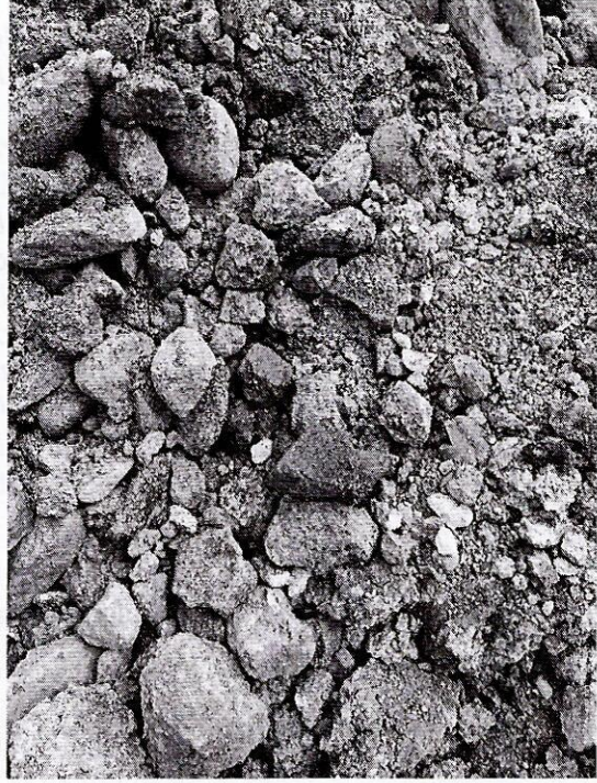
Escombros de ladrillo en rellenos
